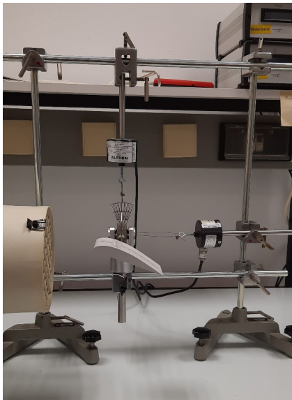
Abbildung 5: Aufbau zur gleichzeitigen Messung von Auftriebs- und Widerstandskraft.
