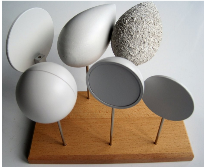
Abbildung 7: Zur Verfügung stehende Widerstandskörper.
